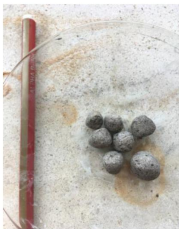
Εικόνα 4.3.1. Δοκιμαστικά σφαιρικά συσσωματώματα (pellets) από ομογενοποιημένη ποσότητα ιπτάμενης τέφρας (VP_FA_COMP) (αριστερή φωτογραφία) και εργαστηριακή παραγωγή pellets (δεξιά φωτογραφία).
