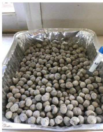
Εικόνα 4.3.1. Δοκιμαστικά σφαιρικά συσσωματώματα (pellets) από ομογενοποιημένη ποσότητα ιπτάμενης τέφρας (VP_FA_COMP) (αριστερή φωτογραφία) και εργαστηριακή παραγωγή pellets (δεξιά φωτογραφία).
